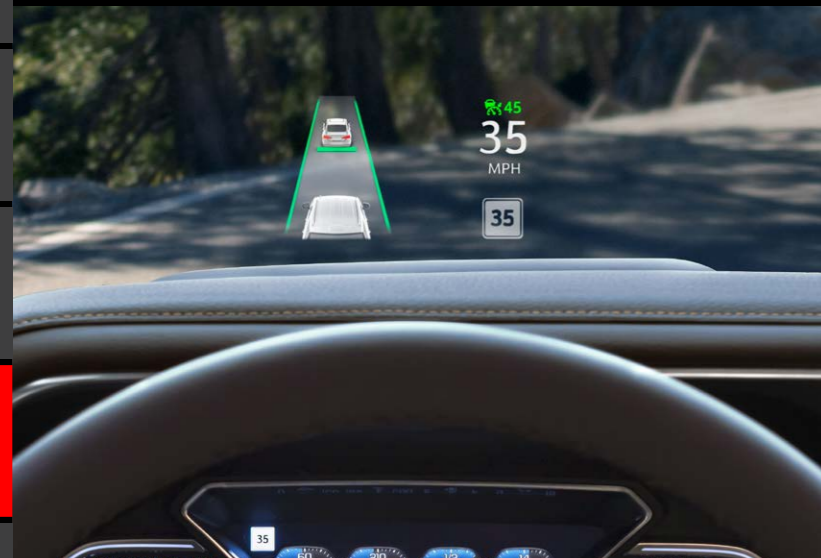
Head Up Display a color de 15", que proyecta en el parabrisas información como navegación, música, inclinómetro y velocidad.
