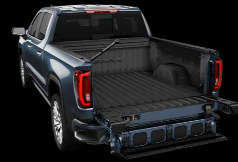
Apertura primaria con escalón de acceso y barra de apoyo plegable
