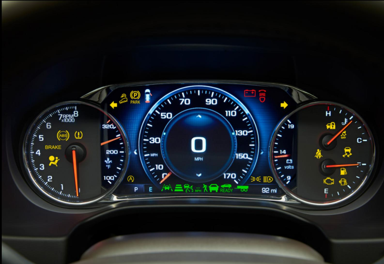
Clúster de información para el conductor con pantalla de 8" a color reconfigurable
