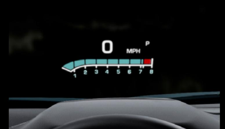
Head Up Display de 6". Refleja en el parabrisas la información que necesitas con funciones a color y reconfigurable
