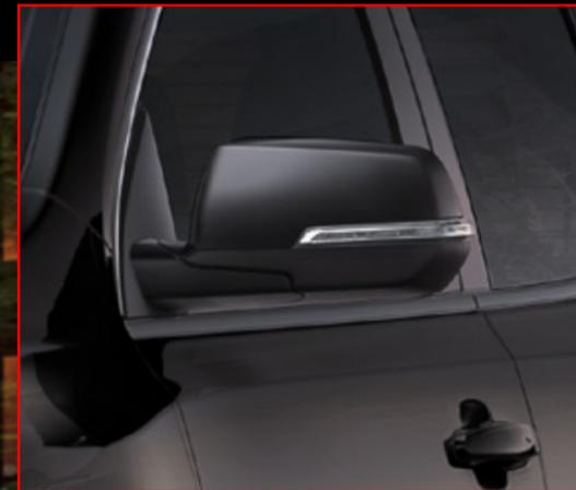
Espejo retrovisor electrocromático con ajuste eléctrico y direccional incluida
